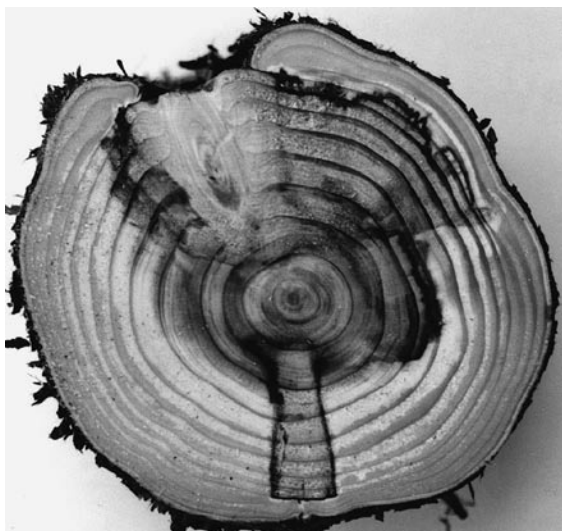
▼写真③ 大きな傷により形成された傷害心材
