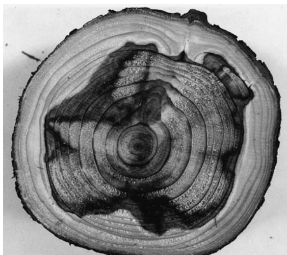
▲写真① 磨き丸太に見られるボタン材
