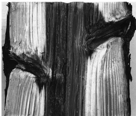
▲写真⑤ 黒心の個体の縦断面 (枝や節の部分も黒褐色である)
