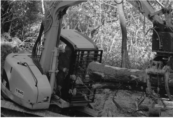
▲写真⑤ 林業機械を操作する武山部長（油圧ホースは5系統設置しハーベスタへの転用も検討している）
