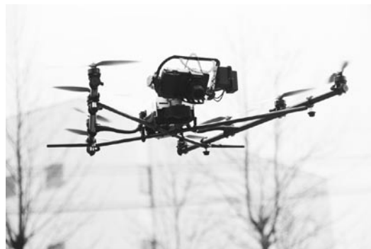
▲写真② UAVによる空撮風景。Falconは8基のローターが搭載されている。
