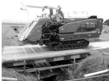
▲写真① プレストレス木床板橋の載荷実験 (写真提供：(株)室岡林業)
