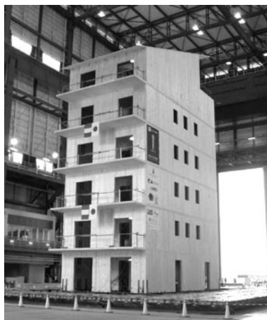
▲写真③ イタリア震動台実験
