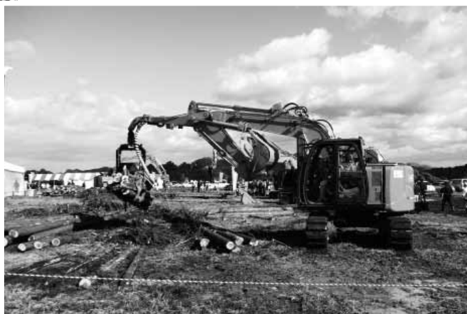
▼写真⑪ ハーベスタバケットハイブリット機の NGH-35 (通常のバックホウに、収納可能なハーベスタを搭載)
