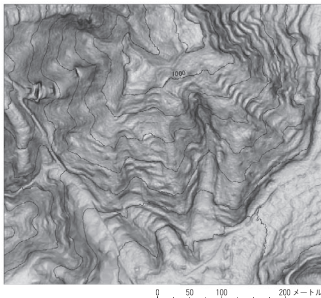
▲図⑤ 航空レーザ測量1mメッシュDEMをGISソフトによって作成した微地形図（長野県林業総合センター作成。）
