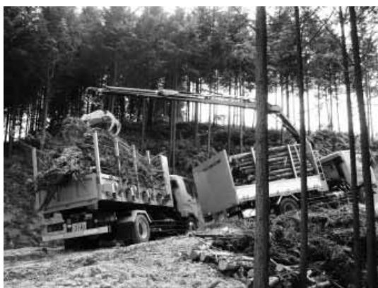
▲写真③ NEDO 事業で開発した「簡易圧縮機能付きトラック」及び「ロングアームグラップル付きトラック」を活用した森林バイオマス等の収集状況
