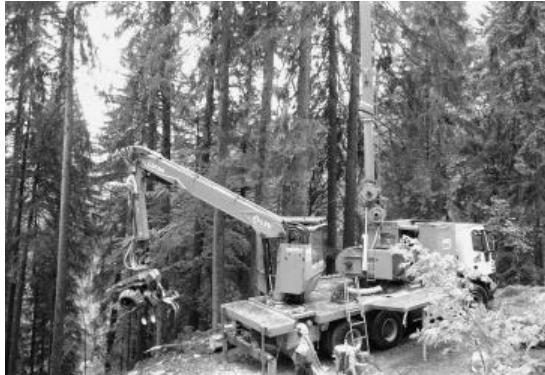
▲写真② タワーヤーダとハーベスタヘッドの併載車両
