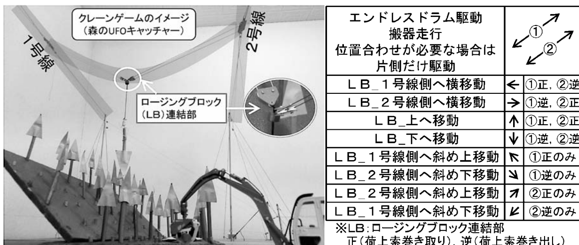
▲図① H型架線のイメージ(模型)と動作について
