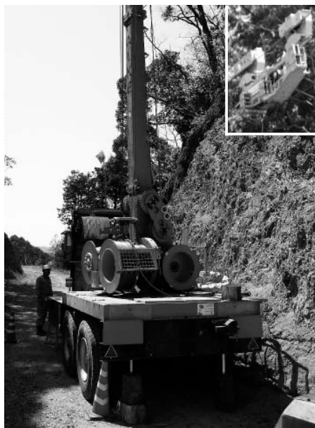
▲写真② けん引式タワーヤード WANDERFALKE (平成 23 年 3 月、高知県での現地実証試験地にて)
