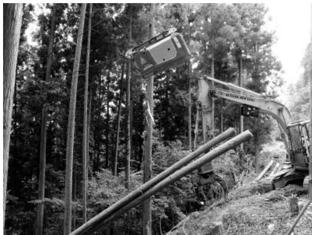
▲写真① 特殊搬器 LIFTLINER (平成 23 年 9 月、広島県での現地実証試験地にて)
