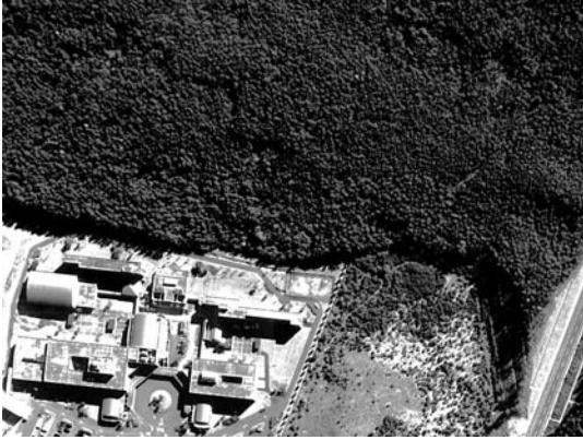
▲図② 海岸クロマツ林の赤外線航空写真（針葉変色木の樹冠は画像上で白く浮き出たように写っている。）
