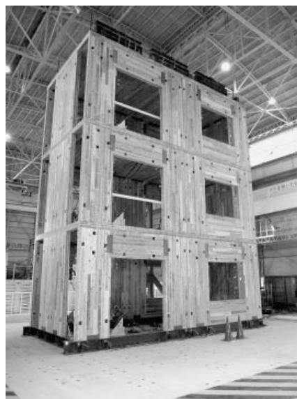
▲写真⑥ 直交集成板（CLT）を用いた 3 階建て構造物の実大加震実験（2011 年、つくば）
