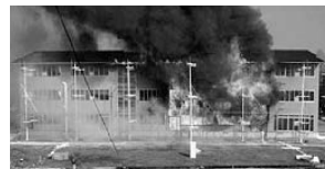
▲写真⑤ 外壁開口部から上階延焼する様子(第一回実験：点火後15分)
