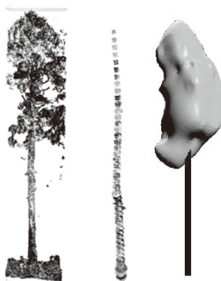
図：地上レーザによって取得したデータ（左）、幹部のみ抽出した結果（中央）、ラッピング法により樹冠部形状を把握した結果
