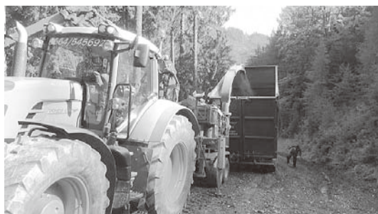
▲写真④ チップトラクターを用いた山土場チップ化
