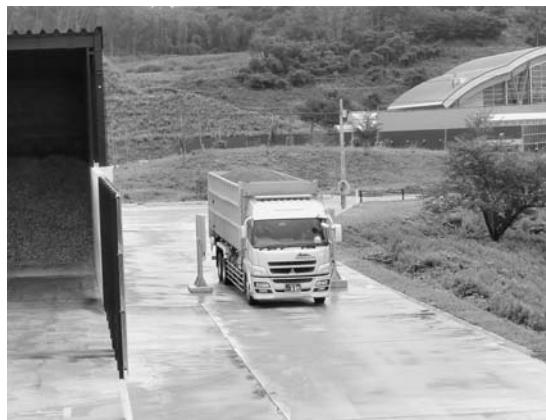
▲写真② ゲート式放射能測定器
