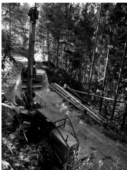
◀写真④ 国産タワーヤーダと自走式搬器の組み合わせによる集材
