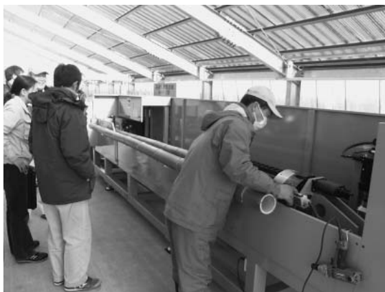
▲写真⑤ 高速竹粉製造機
