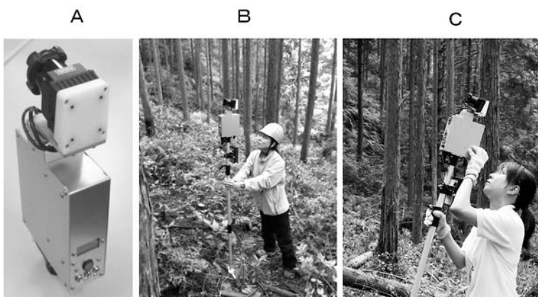
▲図① レーザ計測装置（A），計測作業（B），操作の様子（C）
