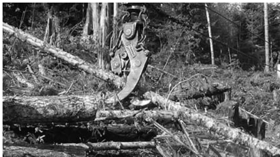
▲写真⑥ グラップル搬器付きスイングヤードによる集材 グラップル搬器を材の上に落として材をつかむことができるため、荷かけ手は不要。
