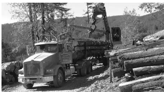
▲写真⑦ ポールトレーラー・トラック 空荷の場合はトレーラの連結器を外し、トレーラを背負って移動する（右）。 米国西海岸ではこの方式が一般的である。
