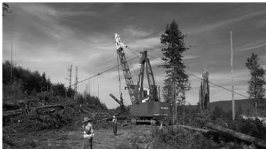
▲写真⑥ グラップル搬器付きスイングヤードによる集材 グラップル搬器を材の上に落として材をつかむことができるため、荷かけ手は不要。
