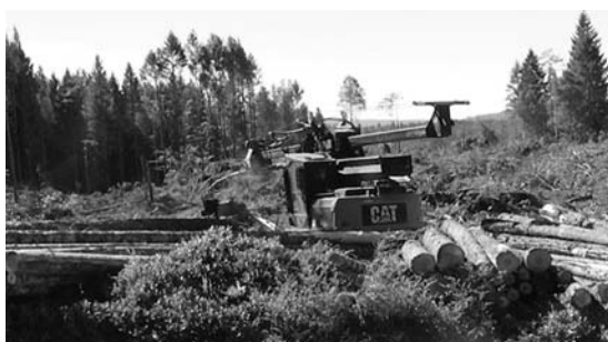
▲写真⑤ ストロークデリマによる玉切りと枝払い
