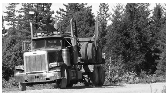
▲写真⑦ ポールトレーラー・トラック 空荷の場合はトレーラの連結器を外し、トレーラを背負って移動する（右）。 米国西海岸ではこの方式が一般的である。
