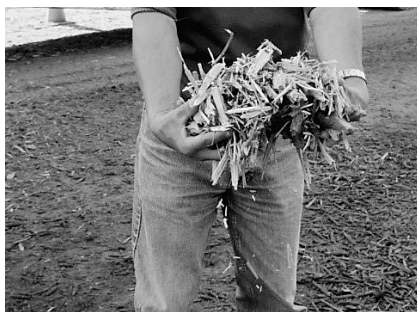
◀写真② Peterson 5710C 水平グラインダで生産された hog fuel と呼ばれる破砕チップ
