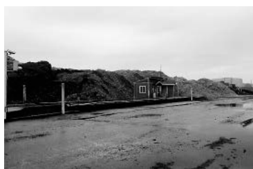
▲写真⑤ トラックスケール（左）とチップの山（右） チップはダンプされ、ショベルローダによって運搬される。10分程度で荷下ろしの全工程が完了する。
