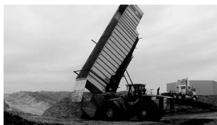
▲写真⑤ トラックスケール（左）とチップの山（右） チップはダンプされ、ショベルローダによって運搬される。10分程度で荷下ろしの全工程が完了する。
