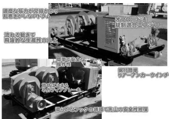
▲図② 開発した油圧集材機
