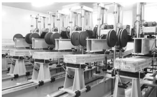
▲写真⑤ CLT の長期挙動測定装置
