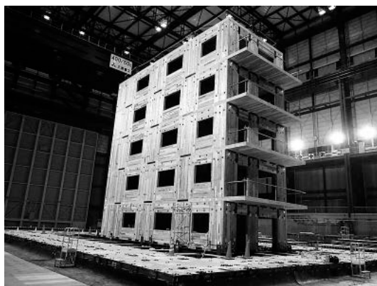
▲写真② 震動台実験
