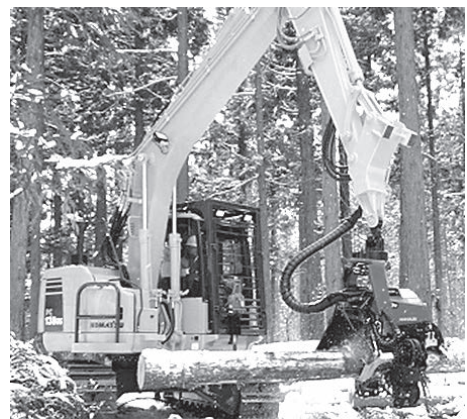
▲写真② PC138US-10 ハーベスタ仕様車 (ヘッド：コマツフォレスト製 350.1)
