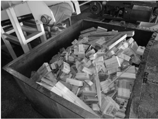
▲写真① ラミナを製造するためには死に節や抜け節、腐れなどの欠点部分を除去する必要がある
