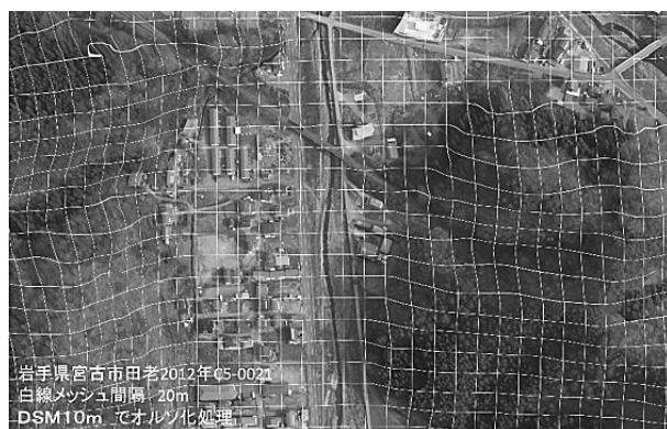
▲図⑥ 立体 DSM による精密オルソの歪み 岩手県宮古市田老 2012 年 C5-0021 白線メッシュ間隔 20m DSM10m でオルソ化処理
