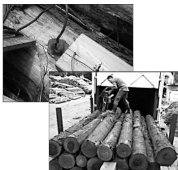
▲図① 熱処理装置 性能評価試験の様子と取得データ（熊本県林業研究指導所） 右グラフの上部折れ線群は庫内各所の温度変化経緯。中段は材芯部に設置したセンサー（左上写真参照）からの材温変化の経緯。下部は装置の外部壁面温度。
