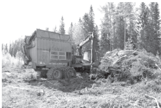
▲写真⑤ 林道端に桎積みされた林地残材とバイオマス燃料用の移動式チップパー 林地残材は一年ほど乾燥させてある。桎積みされた林地残材はスウェーデンでは GROT と呼ばれ、現場でも用語として一般的に用いられていた。
