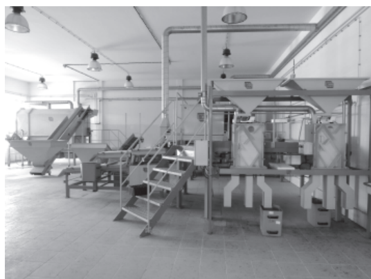
▲写真① スウェーデン BCC 社の種選別システム 奥の機械で種の洗浄を行ってから真ん中の機械でサイズごとにふるいにかけ、手前の重力式ふるいで重量によって中身のある種と空の種を分ける（セルビア国、ボジェガ国营シードセンターにて 2015 年撮影）。
