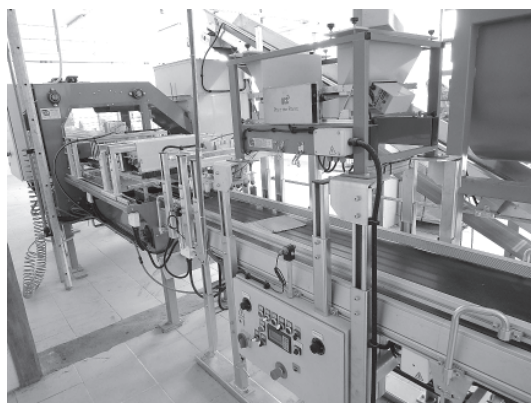
▲写真② 同社のコンテナへの土詰め、穴あけ、種まきを一貫して行う機械（セルビア国、ボジェガ国营シードセンターにて 2015 年撮影）
