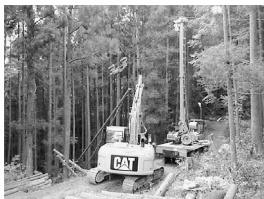
▲写真① 集材作業の状況(手前; プロセッサ, 奥; タワーヤード) プロセッサ(造材機械)の運転席から遠隔操作して、搬器を動かしている様子。
