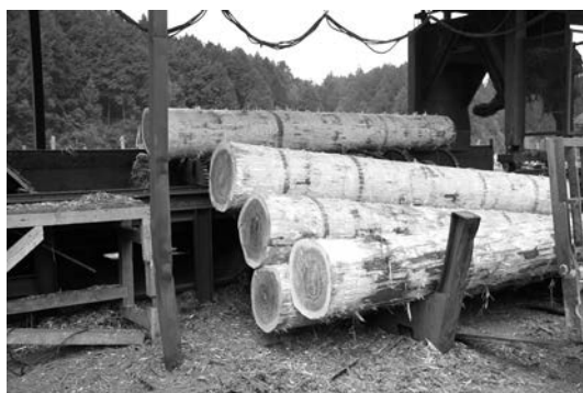
▲写真① 径級 40cm 上はカッターバーカーで剥皮 (熊本県上球磨森林組合製材工場)
