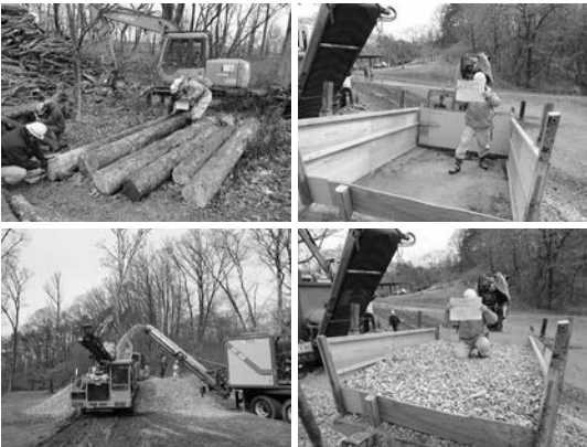
▲写真① 調査風景 左上：丸太の材積調査 右上：チップ化前（フォワーダが空荷であることの確認） 左下：調査した丸太のチップ化 右下：丸太のチップ化後（チップを均し、容積を確認）
