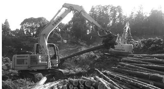
▲写真③ 高性能林業機械（プロセッサ）
