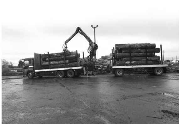
▲写真② 22tトラック＋15tフルトレーラー
