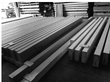
施主、設計士、工務店による 主要構造材の検査
