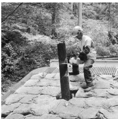
▲伐倒練習機 Felling Trainer MTW-01 (P.20-21 参照) で基本技術を確認する。何度でも同じ条件で練習できるので初心者・指導に最適。
