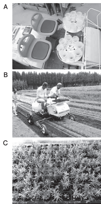
▲写真③ タマネギ用移植機(A)を活用したスギ苗の植え付け作業(B) 機械に座ったままターンテーブルのカップの中にセル苗(C)を入れていくだけの簡単な操作で、次々とセル苗が植え付けされていく。また、植え付けと同時に灌水する装置もついているため、植え付け後の灌水作業が不要で活着も良い。
