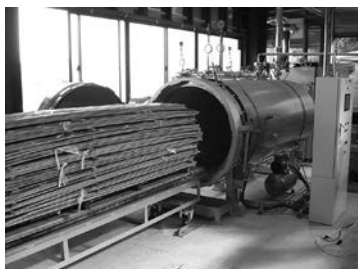
▲写真④ 工場の様子(乾留釜) 虫が竹を食べるのを防ぐため、竹に含まれる糖分・アミノ酸・ポリフェノール等を取り除く、乾留を行う機械です。
