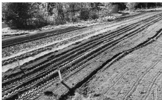
▲写真⑤ 北大研究林における踏圧試験地（写真右手前から左奥にかけて杭を境に踏圧強度を増加させている）
