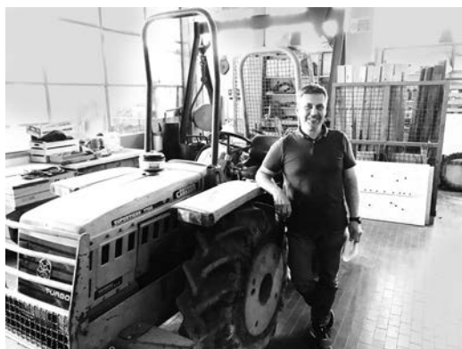
▲写真① フィレンツェ大学の踏圧実験で使用されたトラクター (重さ約 2t、タイヤ幅は約 20cm)
