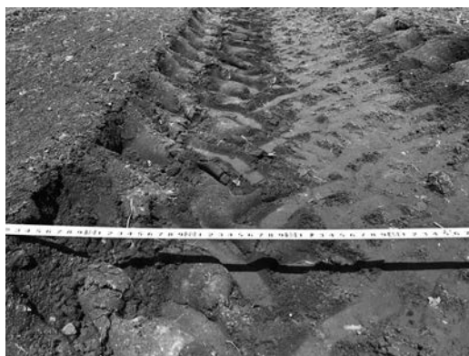
▲写真② ホイールで踏圧された土壌表面 (走行回数が増すことで、タイヤ跡が消える)
