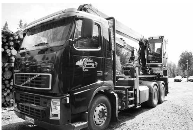
▲写真② フィンランドで稼働していた遠隔操機能、グラッフル重量計付きトラック 一掴みの重量と合計積載重量が表示される。キャビンは昇降でき視界の確保も容易で、運転席に戻らずともリモコン操作でトラック小移動ができるため、中間土場などでの高い極積みの取り扱いに長けている（2016年）。
