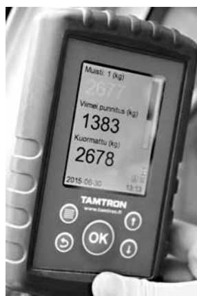
▲写真② フィンランドで稼働していた遠隔操機能、グラッフル重量計付きトラック 一掴みの重量と合計積載重量が表示される。キャビンは昇降でき視界の確保も容易で、運転席に戻らずともリモコン操作でトラック小移動ができるため、中間土場などでの高い極積みの取り扱いに長けている（2016年）。
