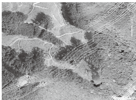
▲図① Google Earth の画像 (大きく断線したり曲がった送電線、途切れた林道)
