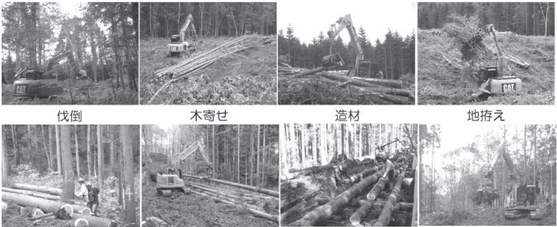
▲写真① 高性能機械多投入による伐出（上段）と従来型伐出（下段）
