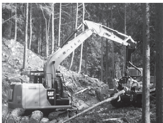
▲写真② 造材した原木をフォワーダに直接積み込む
