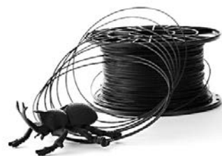
▲写真④ 改質リグニンを利用した 3D プリンター用基材の開発と造形試作への展開（京都府）
