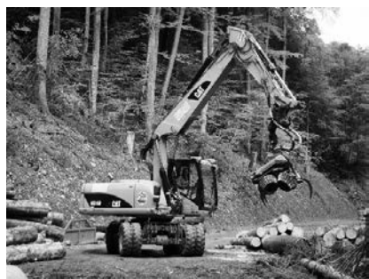
◀写真④ ホイール式ベースマシン 機動的に製品ごとに林道に沿って極積みすることができ、 公道も走行できる（スイス 2018 年）
