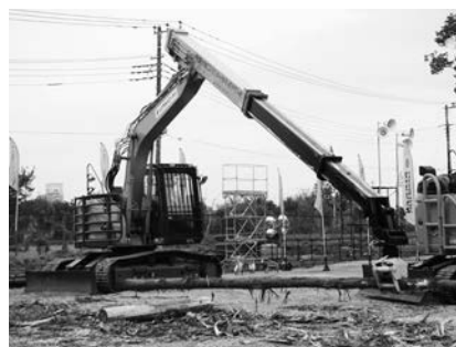
▶写真② ロングリーチグラップル アタッチメントを軽量グラップルソーに換装可能 (森林・林業・環境機械展示実演会 2018 年)
