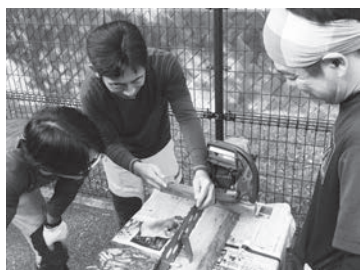
▲大きく痛んだカッター（刃）の修正には補助具を使わず手作業で対応する。切削の理屈を理解することで、イメージ通りの目立てを目指す。
