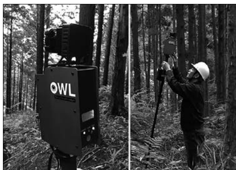
▲図① レーザ計測装置 OWL 一脚式、軽量 (3.7kg) で片手で支えられる
