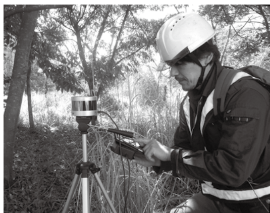
▲ LiDAR（レーザー測距）による森林の三次元観測
