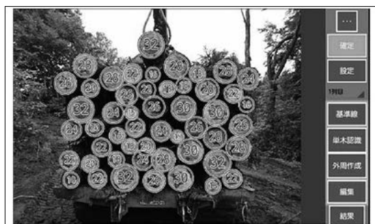
▲図④ 木材検収システムの画像認識画面
