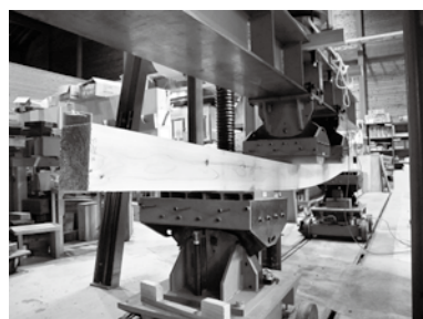
▼写真③ 品の強度試験 （庄原市産平 角材の曲げ）
