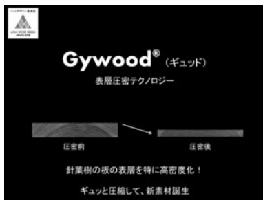
◀図② 「表層圧密技術」の模式図。針葉樹無垢材の硬さや強度を向上。
