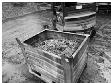
▲写真⑬ ガス化炉に付着していたクリンカ
