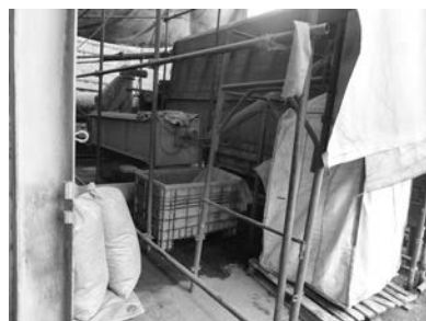
▲写真⑯ 乾燥機裏側の篩と取り除かれた チップ（左下の袋）
