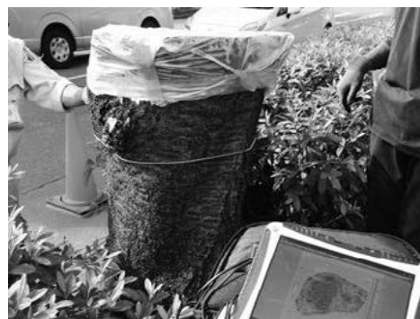
▲写真② 伐採した街路樹のソメイヨシノで腐朽状況と診断画面を照合して診断機器の特性を検証 音波をPCで発振するドクターウッズという機器を使用している例。複数の診断機器を使ったり、円板を採取して材密度、含水率、強度を測定したりすることで検証の効果を高めることができる。
