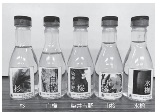
▲写真② 木材から製造した蒸留アルコール 蒸留すると全て無色透明のアルコールになるが香りは樹種ごとに異なる。
