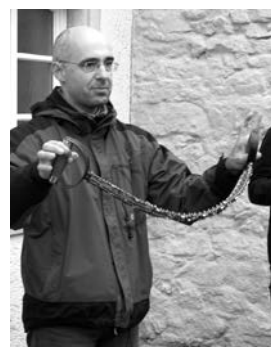
▲写真⑨ 樹皮を剥ぐための ソーチェーンを束ねて作った 道具
