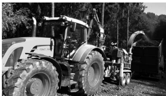
▲写真① 林道を走行可能なチップパートラクタ トラックが半おろしたコンテナに切削チップを 吹き込む様子
