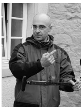
▲写真⑧ 樹皮を剥ぐために 作られた専用の道具 木工で使う、材や樹皮を削 るための銃(セン)やドロー ナイフと似た形状をしている。
