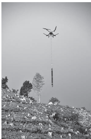
▲写真⑤ 写真④の尾根部分： ドローンによって運ばれる支柱 サブオペレーターは、この奥にいて見えない。
