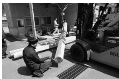
▲写真⑫ 打撃法によるヤング係数の計測
