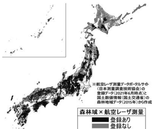
▲図① 森林域における航空レーザ測量の実施状況
