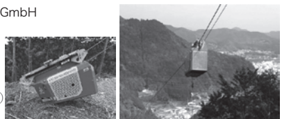
▲図② 導入したトラック搭載式タワーヤーダと高性能搬器
