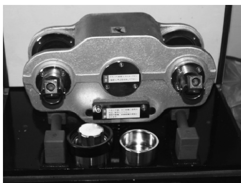
▲写真① アセチル化に用いた高速振動粉碎機と処理容器の外観
