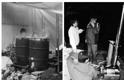
▲写真② ドラム缶風呂(左)と専用の風呂窯(右)での熱効率の検証
