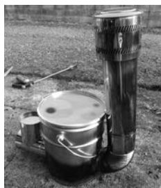
▲写真⑦ 完成した市川式パール缶窯
