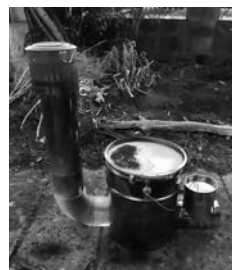
▲写真⑪ 全体が高温になったパール缶窯 煙突トップからはわずかに炎が上がり、えび型煙突とI型煙突は熱せられて赤くなっている。
