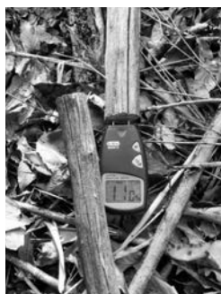
▲写真② コナラ枯損木の含水率（11.0%）簡易木材水分計で計測すると乾燥していた。
