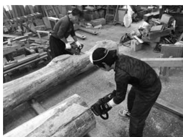
▲写真⑤ ヒノキ丸太にチェーンソーで背割りを入れる
