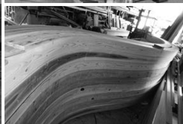
▲写真④ 木型で曲げて積層したスギ板
