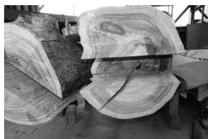
▲写真⑦ ヒノキ丸太柱上部の加工
